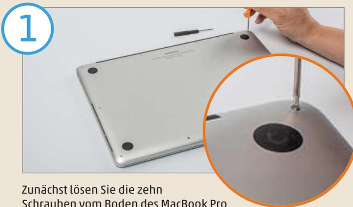
1 Zunächst lösen Sie die zehn Schrauben vom Boden des MacBook Pro und heben dann den Deckel an. Merken Sie sich die Position der Schrauben.
