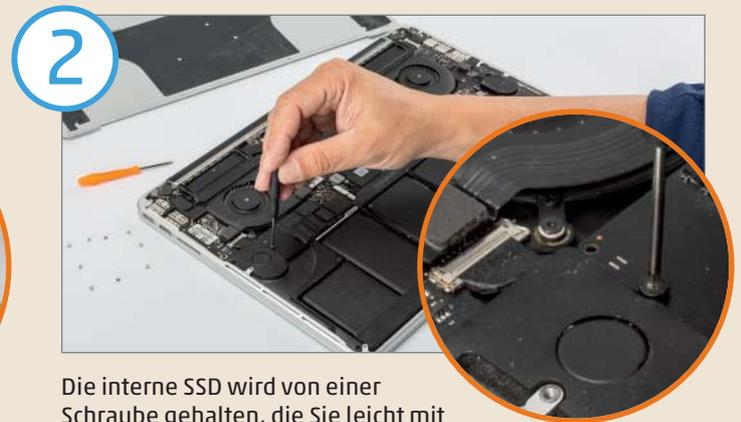
2 Die interne SSD wird von einer Schraube gehalten, die Sie leicht mit einem Torx-T4-Schraubendreher entfernen können.
