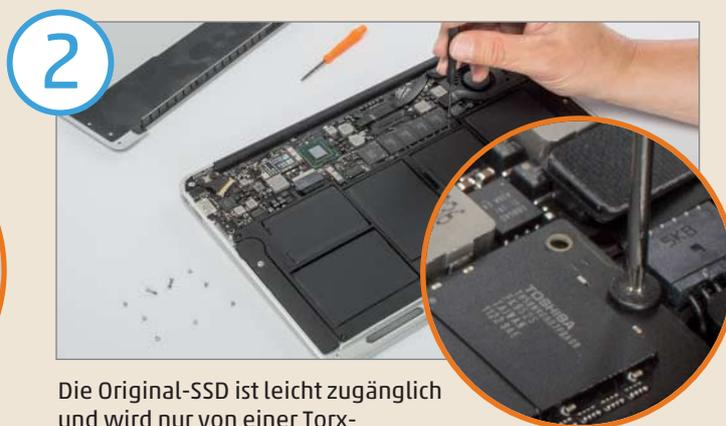
Die Original-SSD ist leicht zugänglich und wird nur von einer Torx-Schraube gehalten. Ziehen Sie den Riegel nach hinten heraus.
