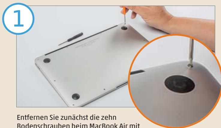
Entfernen Sie zunächst die zehn Bodenschrauben beim MacBook Air mit einem Pentalobe-Dreher. Merken Sie sich die Position der unterschiedlich geformten Schrauben.
