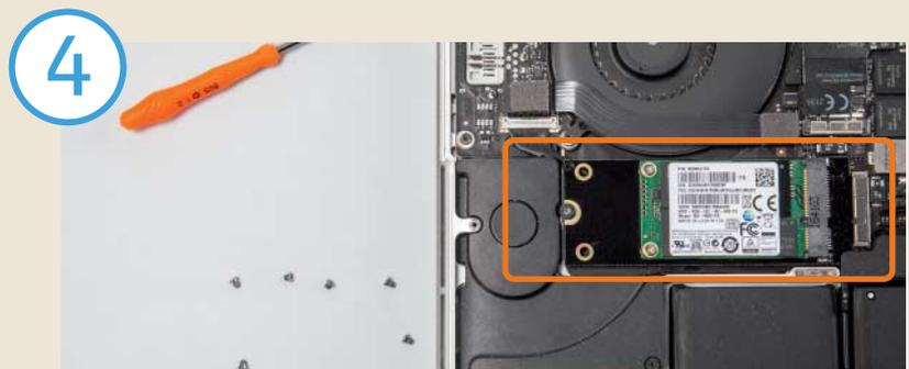
4 Die mSATA-SSD liegt auf der Adapterplatine und wird dort festgeschraubt. Der Gehäusedeckel stößt später dennoch nicht dagegen.
