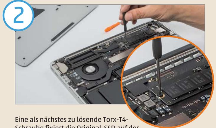
Eine als nächstes zu lösende Torx-T4-Schraube fixiert die Original-SSD auf der Hauptplatine des MacBooks.
