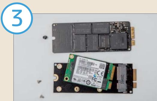
3 Altes (oben) und neues SSD-Modul sind erstaunlich breit, dafür aber kurz. Trotzdem passt 1 TByte auf die Samsung Evo 850.
