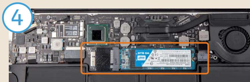
Adapter und Ersatz-SSD passen hintereinander an den Platz des alten Riegels und sind ebenso flach. Schrauben Sie den Deckel wieder drauf.
